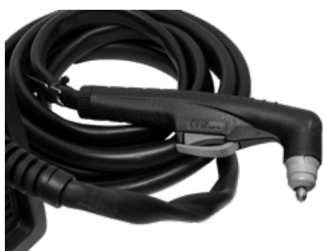
ANTORCHA DE PLASMA CORRECTAMENTE ENSAMBLADA
