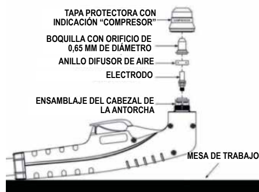
SECUENCIA CORRECTA DE ENSAMBLAJE DE PIEZAS CONSUMIBLES DEL PLASMA
